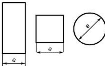
Рисунок ДА.1 — Формы и размеры отверстия
