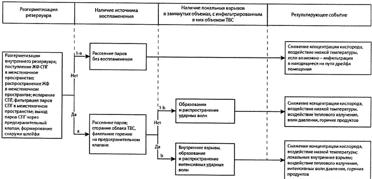
Рисунок 6-4. Пример дерева событий при разгерметизации изотермического резервуара с двумя барьерами безопасности
