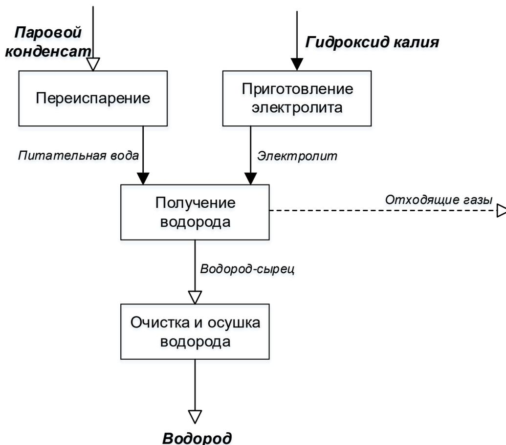
Рисунок 6.1 – Схема производства водорода электролизом воды
