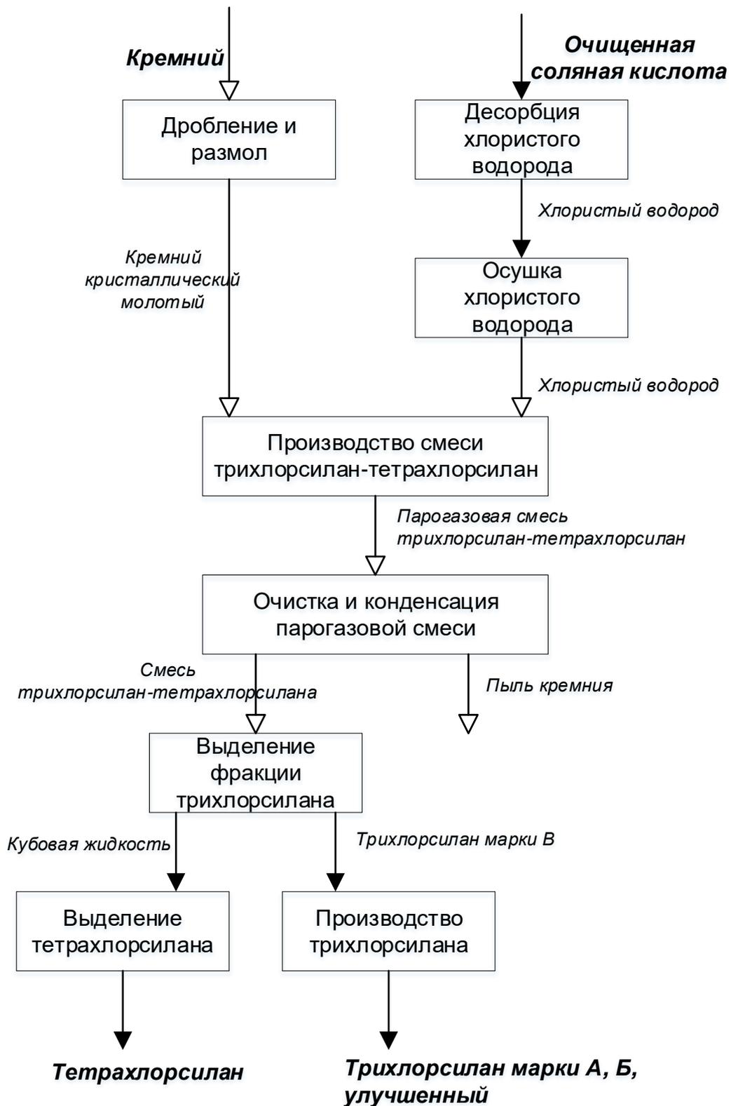
Рисунок 3.1 – Принципиальная схема производства три- и тетрахлорсилана
