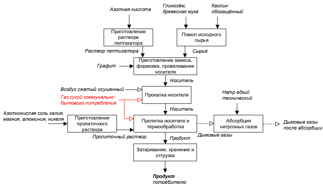
Рисунок 4.1 — Принципиальная схема производства алюмоникелевых катализаторов конверсии метана и углеводородных газов
