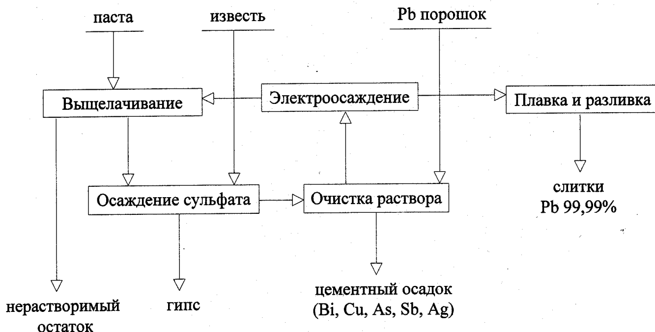
Рисунок 2.22 — Принципиальная схема PLACID-процесса
